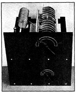
FIG. 946—A HIGH-POWER HIGH-FREQUENCY PUSH-PULL AMPLIFIER
