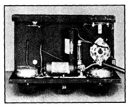
FIG. 1304 — THE UNDER SIDE OF THE TWO-TUBE RECEIVER
