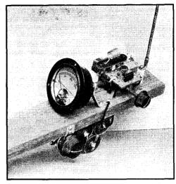
FIG. 1718 — SIMPLE FIELD-STRENGTH METER USING ACORN TUBE
