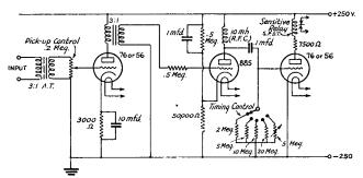
FIG. 1803 — VOICE-CONTROLLED RELAY FOR 'PHONE BREAK-IN WORK
