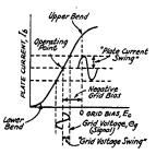
FIG. 502 — OPERATING CHARACTERISTICS OF A VACUUM-TUBE AMPLIFIER
