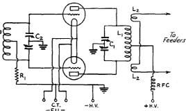
FIG. 1401—A TYPICAL TUNED-GRID TUNED-PLATE OSCILLATOR CIRCUIT SUITED FOR THE LOW-POWERED TRANSMITTER ON THE 56- AND 112-MC. BANDS
