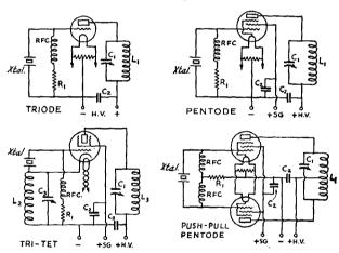
FIG. 807 — CRYSTAL OSCILLATOR CIRCUITS
