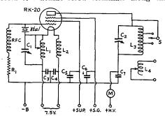
FIG. 920 — THE TRI-TET TRANSMITTER CIRCUIT DIAGRAM
