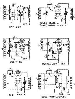
FIG. 801 - SELF-CONTROLLED OSCILLATOR CIRCUITS
