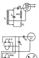
FIG. 926 — ALTERNATIVE OSCILLATOR GRID CIRCUIT CONNECTIONS FOR SELF-CON-TROLLED OPERATION
