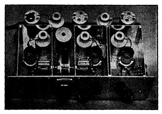
FIG. 718 — A SIX-TUBE REGENERATIVE SINGLE-SIGNAL SUPER-HETERODYNE RECEIVER
