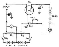
FIG. 1717 — SIMPLE PEAK-TYPE VACUUM-TUBE VOLTMETER
