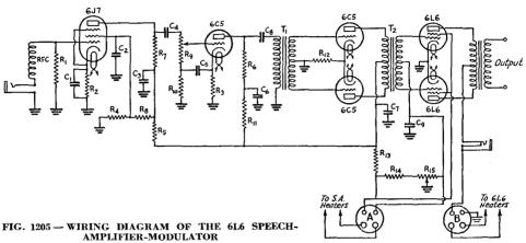
$C_1 - 10$ - $\mu fd.$ , 25-volt electrolytic.  $C_2$ ,  $C_3 - 2$ - $\mu fd.$ , 200-volt electrolytic.  $C_4 - 0$ .1- $\mu fd.$  paper, 400-volt.  $C_5 - 0$ .5- $\mu fd.$  paper (or larger).  $C_6$ ,  $C_7 - 4$ - $\mu fd.$ , 400-volt electrolytic.  $C_8 - 0$ .25- $\mu fd.$  paper, 400-volt.  $C_9 - 25$ - $\mu fd.$  electrolytic, 50-volt.  $C_1 - 5$  megohms,  $\frac{1}{2}$  watt.  $C_2 - 25$ - $\mu fd.$  electrolytic, 50-volt.
