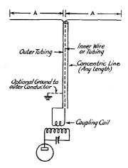
FIG. 1619—HALF-WAVE ANTENNA WITH CON-CENTRIC TRANSMISSION LINE
