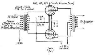
FIG. 607 -- AUDIO OUTPUT AMPLIFIER CIRCUITS
