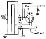
FIG. 1415 — THE CIRCUIT OF THE TROUGH-LINE CONTROLLED TRANSMITTER
