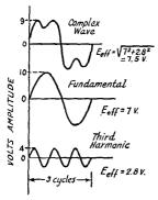
FIG. 307 — A COMPLEX WAVE AND ITS SINE-WAVE COMPONENTS
