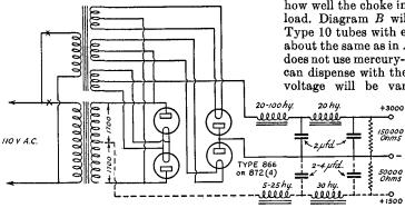
FIG. 1508—HIGH POWER BRIDGE RECTIFIER CIRCUIT
