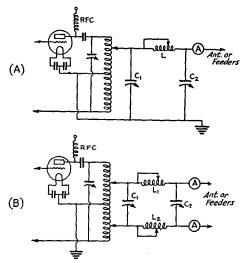
FIG. 1626 - ANTENNA-COUPLING FILTERS
