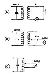
FIG. 1631 - DUMMY ANTENNA CIRCUITS
