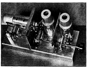
FIG. 1315 — THE GLASS-TUBE CONVERTER UNIT
