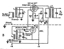
FIG. 613 — THESE FREQUENCY-CONVERTER CIRCUITS ARE FOR USE WITH PENTAGRID TUBES
