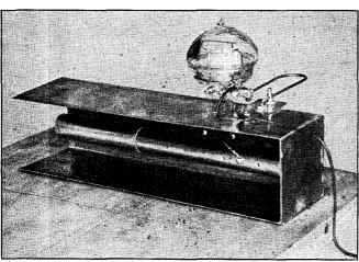
FIG. 1416 — A CONCENTRIC-LINE-CONTROLLED TRANSMITTER USING THE TROUGH-TYPE LINE AND THE W.E. 316-A TUBE
