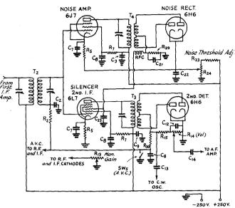
FIG. 628 — SILENCER CIRCUIT APPLIED TO THE SECOND I.F. STAGE OF A TYPICAL SUPERHET. THIS CIRCUIT IS NOT ADAPTABLE TO RECEIVERS IN WHICH A COMMON BIAS CIRCUIT IS USED FOR I.F. AND AUDIO CONTROL GRIDS, THE NEGATIVE-B OF THE HIGH-VOLTAGE SUPPLY MUST BE GROUNDED AT THE FILTER OUTPUT
