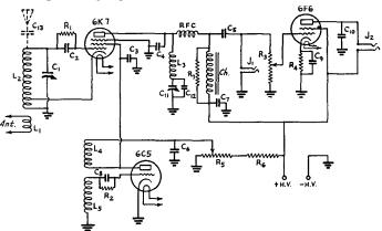
FIG. 1310 — CIRCUIT OF THE SEPARATELY-QUENCHED RECEIVER
