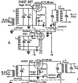
FIG. 614—CONVERTER CIRCUITS EMPLOYING SUPPRESSOR-GRID INJECTION
