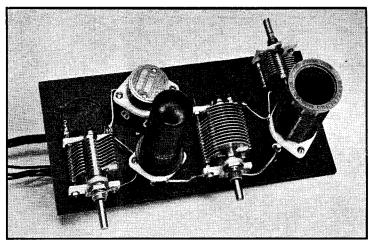
FIG. 908 — A SIMPLE TWO-BAND TRANSMITTER USING A 6L6
