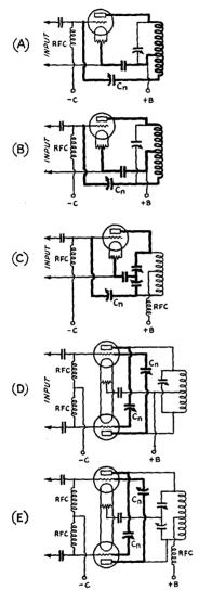
FIG. 818 — PLATE NEUTRALIZING CIRCUITS
