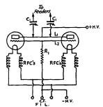
FIG. 1407 — A PUSH-PULL VERSION OF THE LINEAR OSCILLATOR
