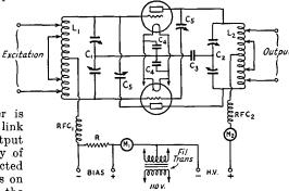
FIG. 942 - CIRCUIT OF THE PUSH-PULL AMPLI-FIER
