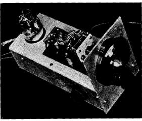
FIG. 1305—A SELF-QUENCHED RECEIVER USING THE ACORN TUBE TO PERMIT OPERATION UP TO 224 MC.
