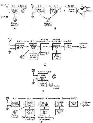
FIG. 601—BLOCK DIAGRAMS SHOWING THE ESSENTIAL UNITS OF BASIC RECEIVER TYPES. A, SIMPLE REGENERATIVE; B, TUNED R.F. REGENERATIVE; C, SUPERHETERODYNE; D, SUPER-REGENERATIVE; E, SUPER-INFRAGENERATIVE. THE LAST TWO ARE ULTRA-HIGH FRE-QUENCY TYPES
