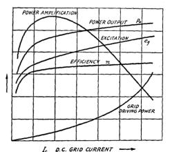
FIG. 812 — EFFECT OF GRID EXCITATION ON
