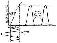
FIG. 508 - OPERATION OF THE CLASS-B AMPLIFIER
