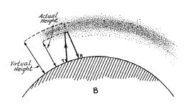
417 — ILLUSTRATING GROUND-WAVE SKY-WAVE TRANSMISSION OF RADIO WAVES
