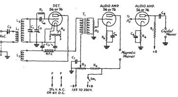
FIG. 704 - THE SIMPLE CIRCUIT OF THE TWO-TUBE TRIODE RECEIVER
