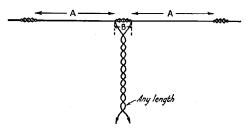
FIG. 1614 — A HALF-WAVE ANTENNA CENTER-FED BY A TWISTED PAIR LINE
