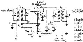
FIG. 625 — HIGH-SELECTIVITY REGENERATIVE I.F. AMPLIFIER CIRCUIT
