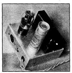
FIG. 1517 — LOW-POWER RECEIVER POWER SUPPLY
