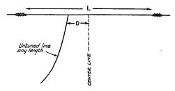
FIG. 1611 — SINGLE-WIRE FEED SYSTEM
