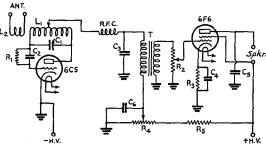
FIG. 1303 — CIRCUIT OF THE METAL-TUBE SELF-QUENCHED RECEIVER
