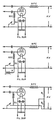
FIG. 1002 — THREE METHODS OF BLOCKED-GRID KEYING
