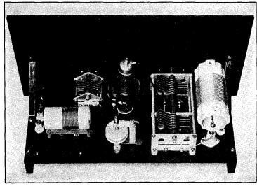
FIG. 937 — A SINGLE-TUBE HIGH-FREQUENCY AMPLIFIER OF MEDIUM POWER
