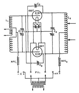
FIG. 945—CIRCUIT DIAGRAM OF THE HIGH-POWER 150T AMPLIFIER
