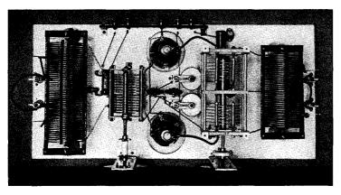
FIG. 941 — A PUSH-PULL AMPLIFIER FOR HIGH-FREOUENCY
