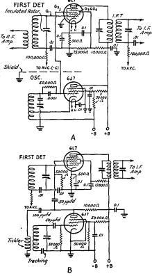
FIG. 616 — CONVERTER CIRCUITS FOR THE 6L7
