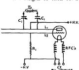
FIG. 1406 — AN OSCILLATOR CIRCUIT SUITED FOR THE VERY HIGH FREQUENCIES
