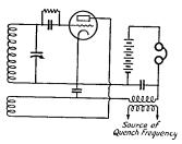
FIG. 514—AN ELEMENTARY SUPERREGENERA-TIVE CIRCUIT
