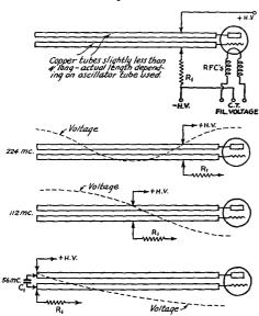
FIG. 1408 — A THREE-BAND ULTRA-HIGH-FREQUENCY TRANSMITTER
